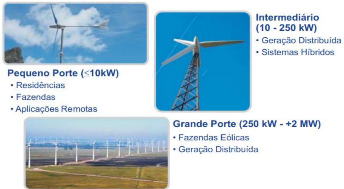
Figura 6 - Considerações sobre o tamanho dos aerogeradores e suas principais aplicações
