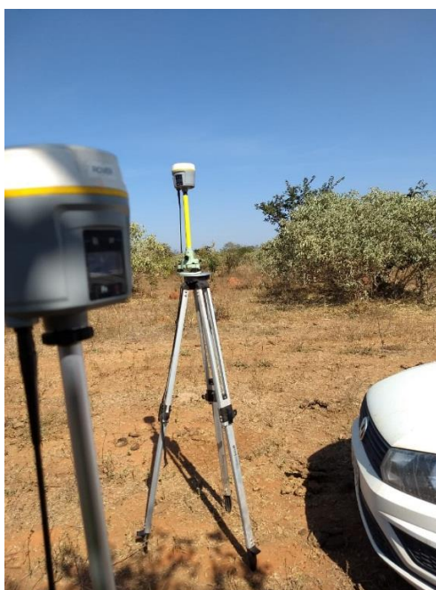
Figura 2: Base do GPS receptor gps Topomap T10 RTK, precisão horizontal de 8 mm.
