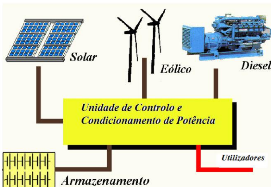
Figura 18 – Tipo de sistema fotovoltaico - Sistema Híbrido
