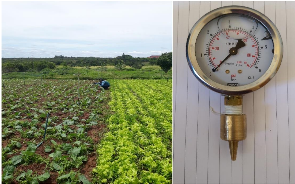
Figura 12– Aferindo pressão do emissor com auxílio de monômetro
