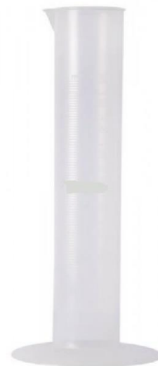
Figura 11– Coleta de lâmina para teste de vazão do emissor
