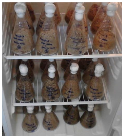
Figura 2 - Fermentação em estado sólido de A. awamori e P. roqueforti realizada em Erlenmeyers.
