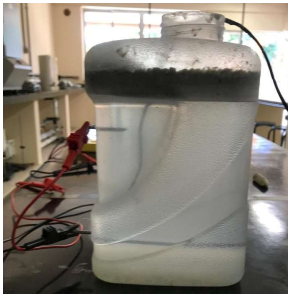
Figura 10- Processo Final da Eletroflotação.
