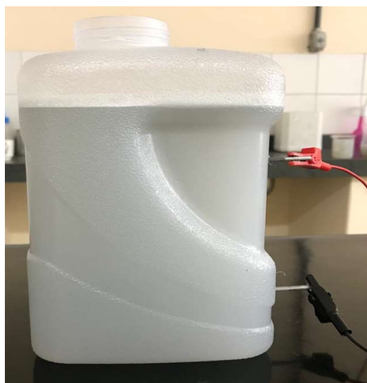
Figura 3- Reservatório plástico com eletrodos de alumínio.
