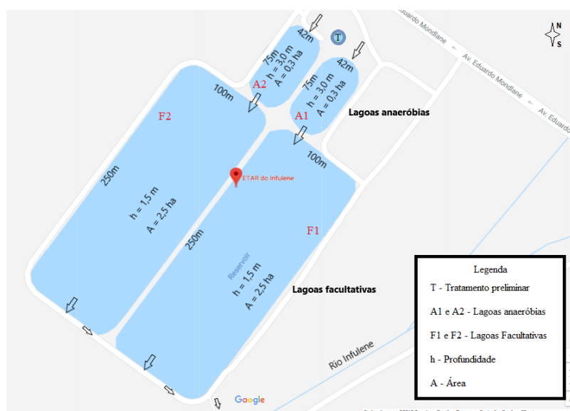
Figura 5 - Esquema da ETAR de Infulene com suas dimensões
