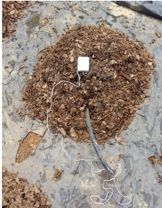
Figura 4 - Medição da temperatura em diferentes pontos das leiras usando termo-higrômetro digital
